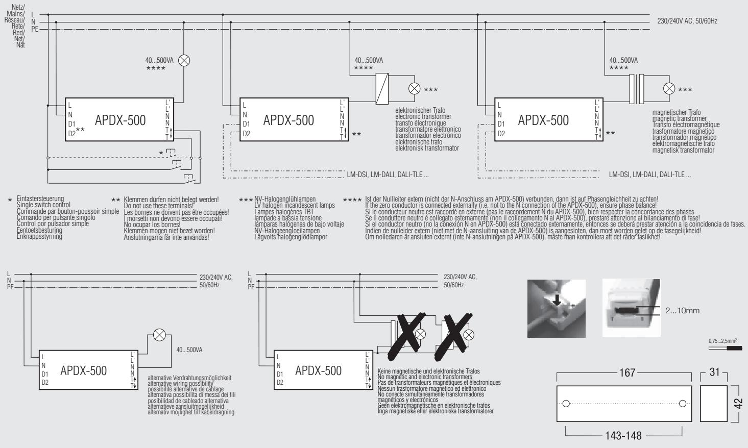
Digitaler Phasenanschrittdimmer oder digitaler Phasenabschrittdimmer zum Dimmen von NV-Halogenlampen mit elektronischen Transformatoren oder magnetischen Transformatoren sowie ohmschen Leuchtmitteln mit einer Gesamtanschlussleistung von 40...500 VA.
