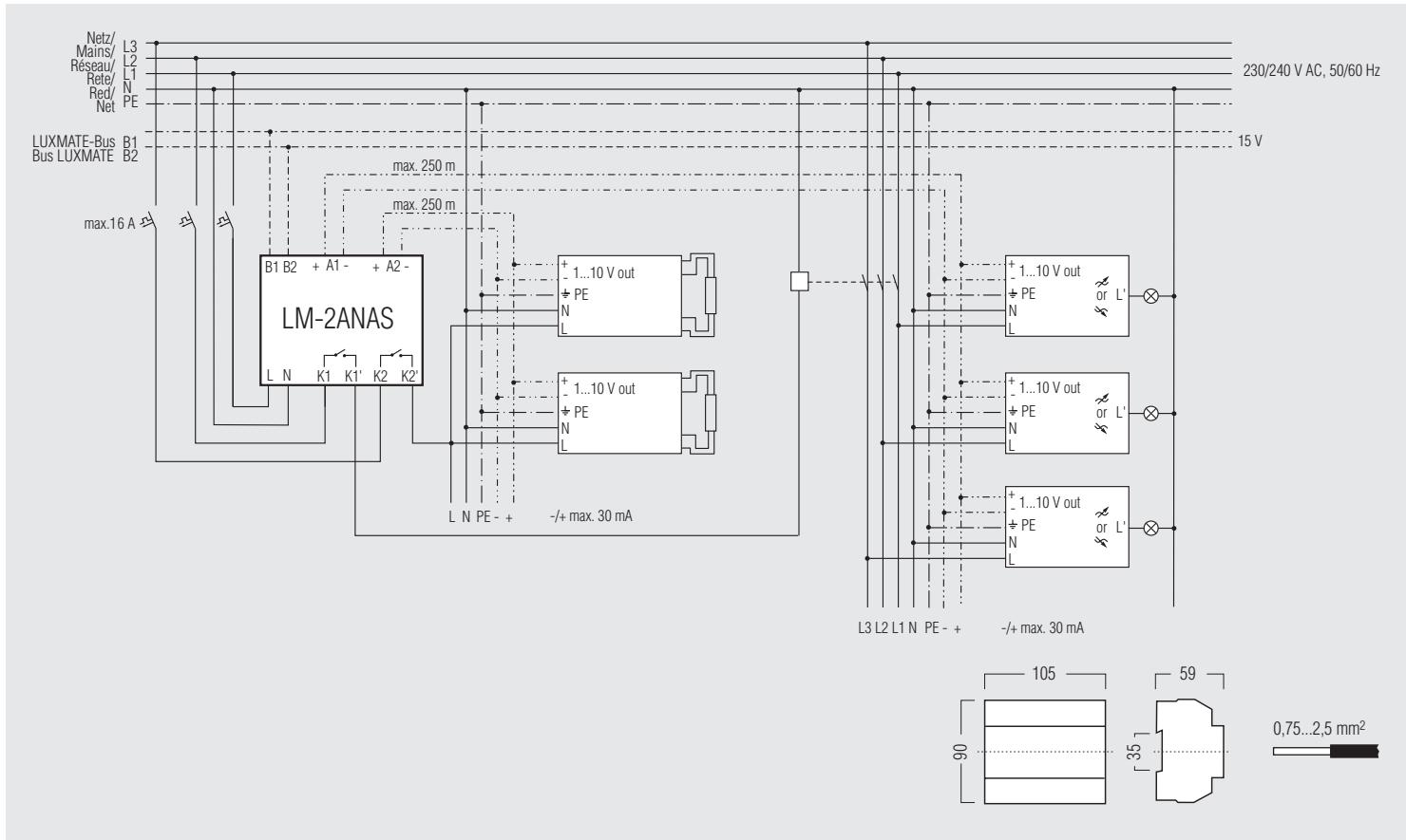
2-fach Analog-Ausgang zur Ansteuerung von Lasten mit 1...10 V-Steuerschnittstelle
