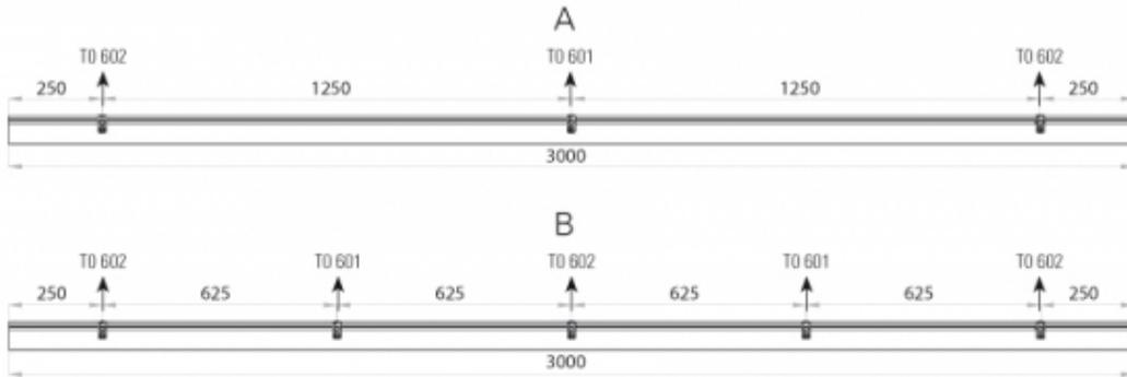
Schema di montaggio cerniere in opera
