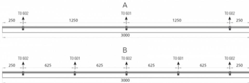
Schema di montaggio cerniere in opera
