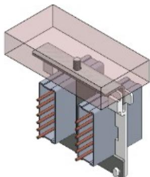
Montare la barretta in plastica prima del fissaggio
