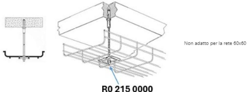
*\*Applicazione del morsetto ancoraggio con inserto filettato sul separatore R0 034*n°1 M6x25 **T0 623 0625**
