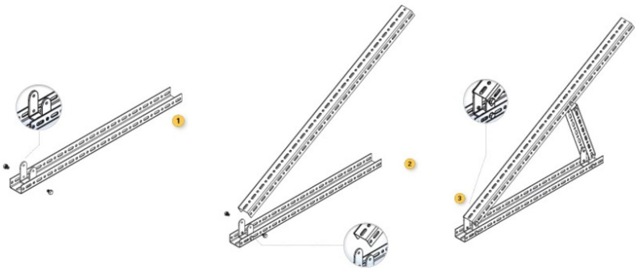
Il giunto cod. E0 321 è stato appositamente progettato per permettere la realizzazione di strutture a triangolo con profilato alte portate.
