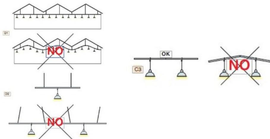
La sospensione del condotto sbarre per risultare eseguita in modo corretto, il suo profilo, al termine dell'installazione deve risultare lineare e perfettamente in piano
