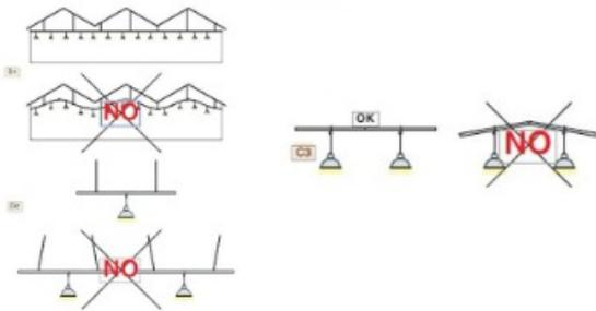
La sospensione del condotto sbarre per risultare eseguita in modo corretto, il suo profilo, al termine dell'installazione deve risultare lineare e perfettamente in piano sia in orizzontale che in verticale, eventualmente intervenire sulle staffe e sulle mensole per allineamento.
