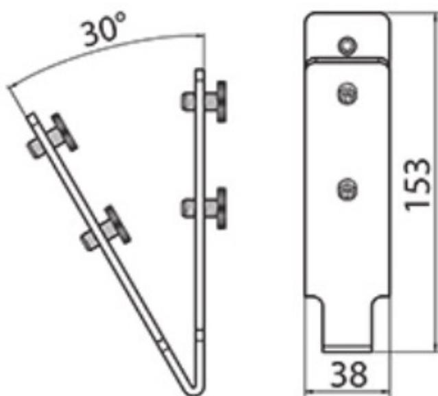
L'elemento è predisposto per la composizione a gradi fissi ma è un sistema a scorrimento interno al profilato stesso (1). La possibilità di serraggi
