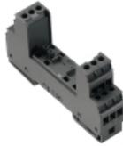
Elemento di base per gli scaricatori innestabili VSPC, piedino PE integrato nello zoccolo VSPC BASE, in grado di collegare a PE fino a 20 kA (8/20 µs) e 2,5 kA (10/350 µs) in modo sicuro.
