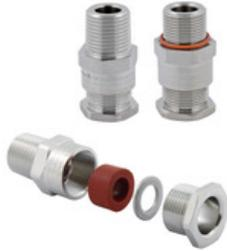
I pressacavi di tipo A2L sono adatti a un cavo non armato, mantengono una protezione a prova di fiamma Ex d e contro le esplosioni a sicurezza aumentata Ex e.
