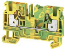
Un'alimentatore di protezione all'interno della morsettiera è un dispositivo con finalità di sicurezza e viene utilizzato in molte applicazioni. Per stabilire il collegamento elettrico e meccanico tra i conduttori in rame e la piastra di supporto di montaggio, vengono utilizzate le morsettiere PE. Hanno uno o più punti di contatto per il collegamento e/o la biforcazione di conduttori di protezione.
