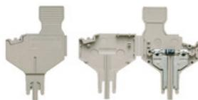
La spina per componenti viene utilizzata per integrare un componente elettrico in una morsettiere di sezionamento. Dopo aver saldato il componente elettronico, la spina può essere integrata nell'area di disconnessione dei nostri morsetti sezionatori e quindi cambia il morsetto sezionatore in un morsetto modulare con componente elettronico integrato.
