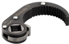
L'utensile di fissaggio Screwty® è indicato per connettori circolari M23 confezionabili liberamente o stampati a iniezione con dimensioni esterne della rondella zigrinata pari a  $26,2 \pm 0,3$  mm. La coppia di serraggio è pari a 2-2,5 Nm.
