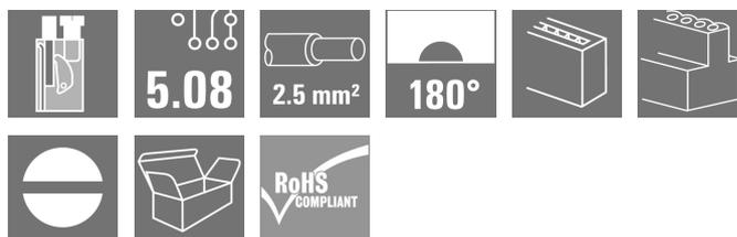
Il connettore femmina con collegamento TOP permette di cablare e stringere la vite dalla stessa direzione consentendo quindi una maggiore densità d'assemblaggio. I connettori femmina sono disponibili anche con coda di rondine (B) per il montaggio dei blocchetti di fissaggio. I connettori BLAT presentano una superficie per la siglatura e sono codificabili. Confezionati in scatole di cartone.
