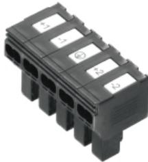
Distribuzione di energia con cavi non tagliati con sezione compresa tra 1,5 e 6 mm<sup>2</sup>. Alimentazione e derivazione a T mediante collegamento PUSH IN (da 0,5 a 10 mm<sup>2</sup>) e/o collegamento ad innesto (da 0,5 a 4 mm<sup>2</sup>). Le siglature colorate assicurano una chiara assegnazione dei conduttori.
