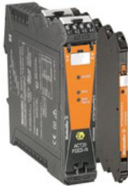
Moduli adattatori di alimentazione per l'alimentazione e la distribuzione separate della tensione per convertitori di segnali della serie ACT20/MICROSERIES. I moduli di alimentazione da 22,5/ 6,1 mm vengono montati accanto ai convertitori di segnali analogici; l'alimentazione a 24 VDC viene ponticellata a richiesta tramite il bus guida CH20M (serie ACT20) oppure semplicemente tramite collegamenti trasversali innestabili ZQV 4N (MICROSERIES).
