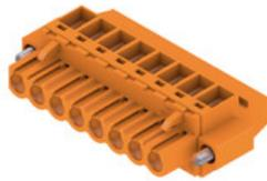
Connettori femmina con collegamento con staffa di serraggio per il collegamento di fili con conduttore angolato a destra (90° o 270°). I connettori femmina dispongono di uno spazio per la siglatura e sono codificabili. Fissaggio per mezzo di flangia o barretta di sgancio. Dispongono anche di una vite più/meno integrata, a protezione contro un errato innesto del cavo, e sono consegnati con le staffe di serraggio aperte. HC = High Current (a corrente forte).
