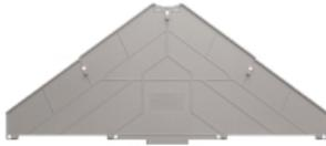
Una piastra divisoria viene utilizzata per la separazione ottica dei circuiti o per l'isolamento elettrico dai connettori trasversali vicini. A differenza della piastra terminale, il contorno può essere più grande delle morsettiere adiacenti. Tuttavia, non dovrebbe essere più piccolo, perché altrimenti non è più possibile mantenere la distanza di sicurezza e le distanze di dispersione richieste all'interno dell'applicazione.
