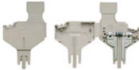
La spina per componenti viene utilizzata per integrare un componente elettrico in una morsettiera di sezionamento. Dopo aver saldato il componente elettronico, la spina può essere integrata nell'area di disconnessione dei nostri morsetti sezionatori e quindi cambia il morsetto sezionatore in un morsetto modulare con componente elettronico integrato.
