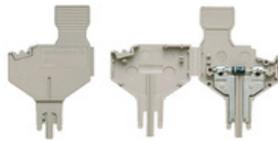
La spina per componenti viene utilizzata per integrare un componente elettrico in una morsettieria di sezionamento. Dopo aver saldato il componente elettronico, la spina può essere integrata nell'area di disconnessione dei nostri morsetti sezionatori e quindi cambia il morsetto sezionatore in un morsetto modulare con componente elettronico integrato.
