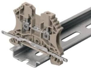
Con le unità LS 2.8 WDU2.5-10, è possibile convertire molto facilmente molti morsetti componibili passanti della serie W. L'inserimento dell'LS 2.8 WDU2.5-10 consente di avvolgere la treccia di schermatura del cavo direttamente sulla morsettiera mediante saldatura o utilizzando un cavo piatto adatto.
