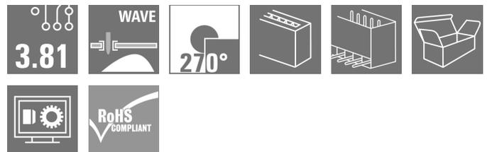
Il connettore maschio SC con direzione d'uscita a 270°; - l'angolo di 270°; viene definito tra la direzione di innesto e il pin brasato e definisce la direzione di innesto parallela rispetto al circuito stampato, ma per l'innesto dei connettori femmina attraverso la testa.
