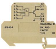
Funzioni logiche AND, NAND, OR e NOR in formato morsetto componibile con una sezione nominale di 4 mm<sup>2</sup>. Dispongono di 5 ingressi in collegamento logico con un'uscita 24 V/ 20 mA PNP. I moduli con funzioni logiche offrono un ampio spettro di applicazioni per l'accoppiamento di segnali digitali da sensori/attuatori con apparecchi d'automazione.
