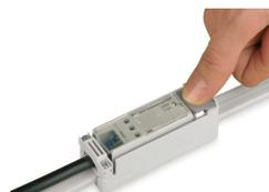
Inserire la parte superiore nella base fino a che entra nel fermaglio (che scatterà quando innestato). Premere in basso e bloccare la leva. Tutte e tre i nuclei entrano in contatto simultaneamente.
