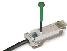
Tagliare il cavo di alimentazione in uscita, spellare completamente e inserire i conduttori. Serrare saldamente le viti (rispettare una coppia di serraggio di 0,7 Nm).
