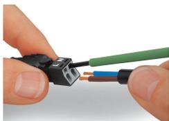
Per collegare i conduttori flessibili, aprire la morsa di contatto con un cacciavite, larghezza lama di 2,5 mm, e inserire un conduttore spelato fino in fondo. Collegare i conduttori rigidi inserendoli con una semplice pressione.
