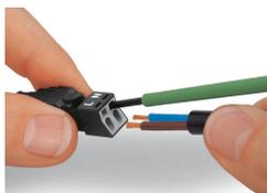
Per collegare i conduttori flessibili, aprire la morsa di contatto con un cacciavite, larghezza lama di 2,5 mm, e inserire un conduttore spelato fino in fondo. Collegare i conduttori rigidi inserendoli con una semplice pressione.
