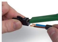
Per collegare i conduttori flessibili, aprire l'unità di connessione con l'utensile (890-382) e inserire i conduttori spelati fino a che toccano il fondo. Collegare i conduttori rigidi inserendoli con una semplice pressione.
