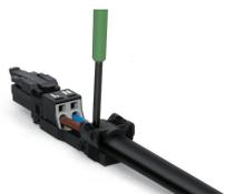
Premere in basso, alternando tra i due lati, il fermacavo dell'antistrappo con un cacciavite largo 2,5 mm.
