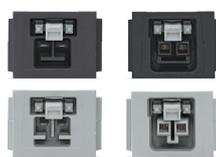
I connettori con codifica B (mostrata in grigio) non divergono solo per il colore ma anche per la struttura, che li rende incompatibili con i connettori codificati diversamente.
