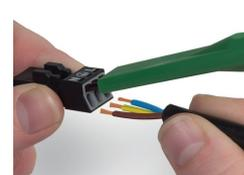
Per collegare i conduttori flessibili, aprire l'unità di connessione con l'utensile (890-383) e inserire i conduttori spelati fino a che toccano il fondo. Collegare i conduttori rigidi inserendoli con una semplice pressione.
