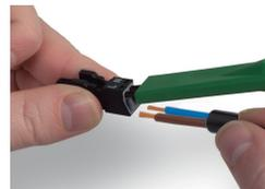
Per collegare i conduttori flessibili, aprire l'unità di connessione con l'utensile (890-382) e inserire i conduttori spelati fino a che toccano il fondo. Collegare i conduttori rigidi inserendoli con una semplice pressione.
