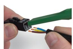
Per collegare i conduttori flessibili, aprire l'unità di connessione con l'utensile (890-383) e inserire i conduttori spelati fino a che toccano il fondo. Collegare i conduttori rigidi inserendoli con una semplice pressione.
