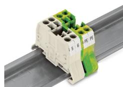
Per poter soddisfare i requisiti di spazio e dispersione per le applicazioni Ex-e, è necessario inserire una piastra intermedia o terminale tra un morsetto di terra e uno passante.
