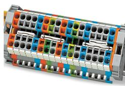
Spingere le barre dei ponticelli fino al completo inserimento. Quando si utilizzano barre multipolari premere alternando a destra e a sinistra fino al fissaggio. Ponticelli a barre a innesto 1 - 3 - 5 - 7 or 1 - - 4 - - 7 a richiesta
