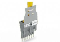
Gruppi modulari con connessioni CAGE CLAMP® (da 0,25 a 2,5 mm<sup>2</sup>/AWG da 24 a 14), comprese le sedi per la piastrina per scarico trazione e per la marcatura con etichette Mini-WSB o WMB.
