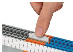
Spingere le barre dei ponticelli fino al completo inserimento. Quando si utilizzano barre multipolari premere alternando a destra e a sinistra fino al fissaggio.
