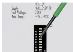
Configurabile mediante DIP switch
