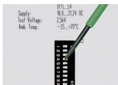
Configurabile mediante DIP switch
