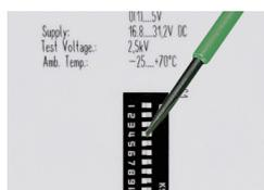
Configurabile mediante DIP switch
