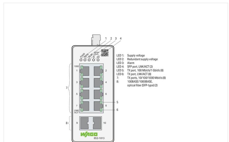
Il modulo 852-1813 è uno switch ETHERNET industriale configurabile, dotato di otto porte 10/100/1000BASE-T e due porte 100BASE-FX/1000BASE-FX/SX/ZX SFP (i moduli SFP sono disponibili come opzione).
