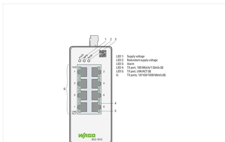
Il modulo 852-1812 è uno switch industriale ETHERNET configurabile dotato di otto porte 10/100/1000BASE-T.
