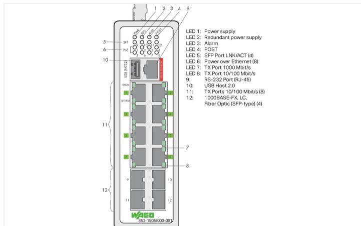
Lo switch Industrial ETHERNET 852-1505/000-001 configurabile dispone di otto porte 10/100/1000Base-T che supportano tutte Power over Ethernet (PoE+) a 30 W, e di quattro porte SFP-1000Base-SX/LX (i moduli SFP sono disponibili come opzione). Tutte le otto porte PoE+ possono funzionare contemporaneamente.
