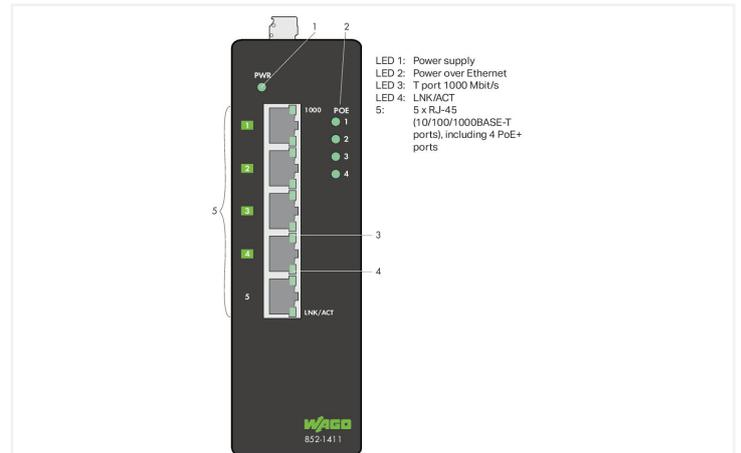
Lo switch Industrial ECO 852-1411 è uno switch ETHERNET 1000Base-T a 5 porte, di cui quattro supportano Power over Ethernet (PoE+) a 30 W. Queste quattro porte PoE+ possono funzionare contemporaneamente per l'alimentazione. Il trasformatore di tensione integrato permette il funzionamento con le alimentazioni a 24 V DC comuni nell'armadio elettrico.
