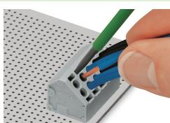
Per inserire/rimuovere i conduttori flessibili aprire la morsa con un cacciavite (lama 3,5 mm).
