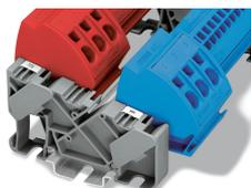
Supporto barra collettore (812-140): offre tre prese per barre collettrici da (10 x 3) mm con dispositivo di bloccaggio per un facile montaggio delle barre collettrici. Il supporto può essere innestato a scatto sulla guida DIN 35 o avvitato a un pannello.
