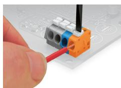
Connessione dei conduttori rigidi: basta spingere il conduttore spelato fino all'arresto in fondo.
