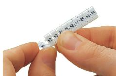
Separazione di una singola etichetta dalla striscia di marcatura WMB: per i morsetti più larghi.
