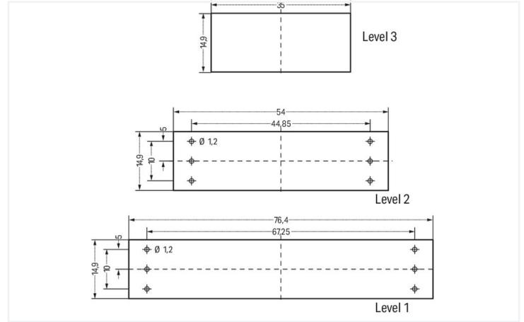
Dimensioni circuito stampato, montaggio verticale: (spessore scheda max. 1,5 mm) nel livello 1; (spessore scheda max. 1 mm) nel livello 2 e 3
