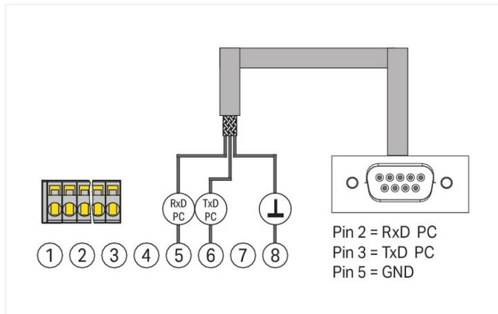
Il cavo 787-890 serve per la configurazione e la visualizzazione tramite PC o controllore.
