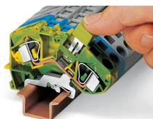
Il collegamento a ponte dei morsetti di terra e dei morsetti passanti è possibile in una sola direzione (tramite la parte posteriore del morsetto) usando ponticelli orizzontali. WAGO raccomanda l'impiego di ponticelli orizzontali giallo-verdi in aggiunta alla marcatura richiesta per questi tipi di morsetti.
