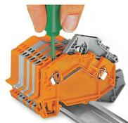
Inserendo a scatto un morsetto di terra sulla guida DIN, viene realizzata automaticamente una connessione elettrica diretta sulla guida.
