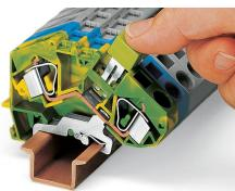
Il collegamento a ponte dei morsetti di terra e dei morsetti passanti è possibile in una sola direzione (tramite la parte posteriore del morsetto) usando ponticelli orizzontali. WAGO raccomanda l'impiego di ponticelli orizzontali giallo-verdi in aggiunta alla marcatura richiesta per questi tipi di morsetti.
